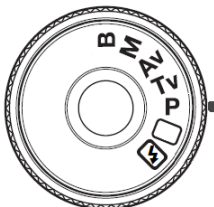
Abb. 3: Modus-Wahlrad (oft mit weiteren Funktionen)
