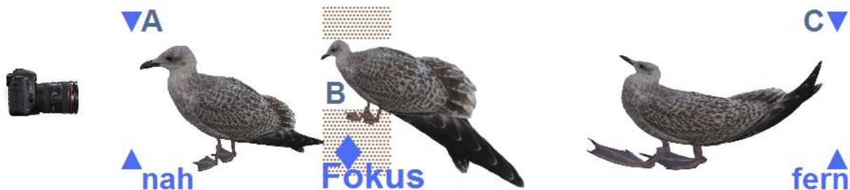
Abb. 1: symbolisiert Bereich B geringer Schärfentiefe, die nur bei der mittig stehenden Möwe liegt. Große Schärfentiefe erstreckt sich von ▼ A bis C▼ und Fokus liegt bei bei ◆
